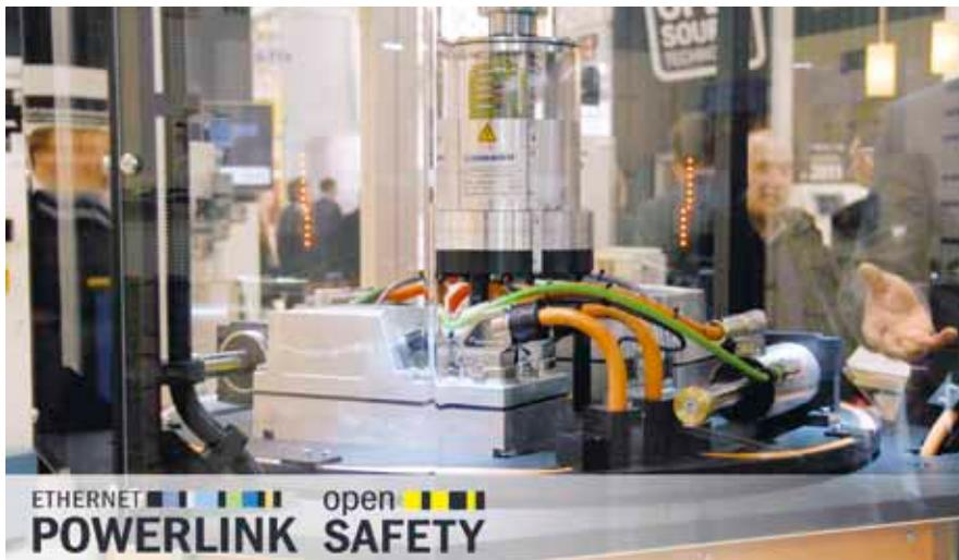
Umfangreiche Tests bestätigten die Zuverlässigkeit der schnellen Datenübertragung mittels POWERLINK über Schleifring.
