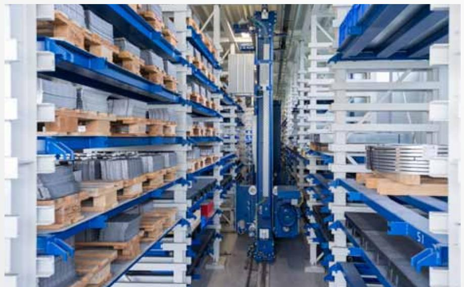
Beispiel für den Einsatz von Leistungswiderständen: Regalbediengerät mit Bremswiderstand für Fahr- und Hubwerk.
