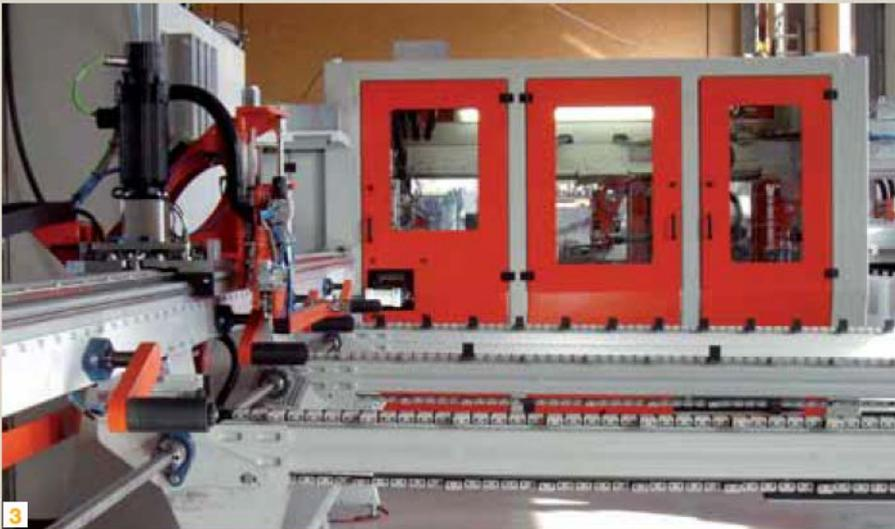
**3** Anlage zur komplexen Bearbeitung von Aluminium-Profilteilen, entwickelt und gebaut vom oberösterreichischen Sondermaschinenbauer Hammerschmid. Bereich der Zuführung der Rohteile: Links im Bild erkennt man den Verfahrwagen, der die einzelnen Profile der Bearbeitung zuführt. Das Greifen und Aufheben erfolgt pneumatisch.
