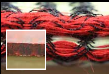
Textile Kunststofffasern, in komplexen Mustern lastrichtig und mit gegenseitiger Unterstützung angeordnet, verbacken zu höchst belastbaren Formteilen.
