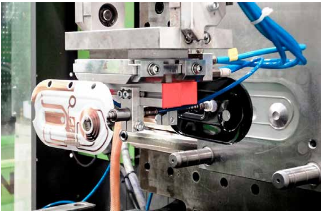
Da die geformte funktionale Folie mechanisch meist noch keinen sinnvollen Teil ergeben würde, muss die Möglichkeit bestehen, das Gebilde zu umspritzen .
