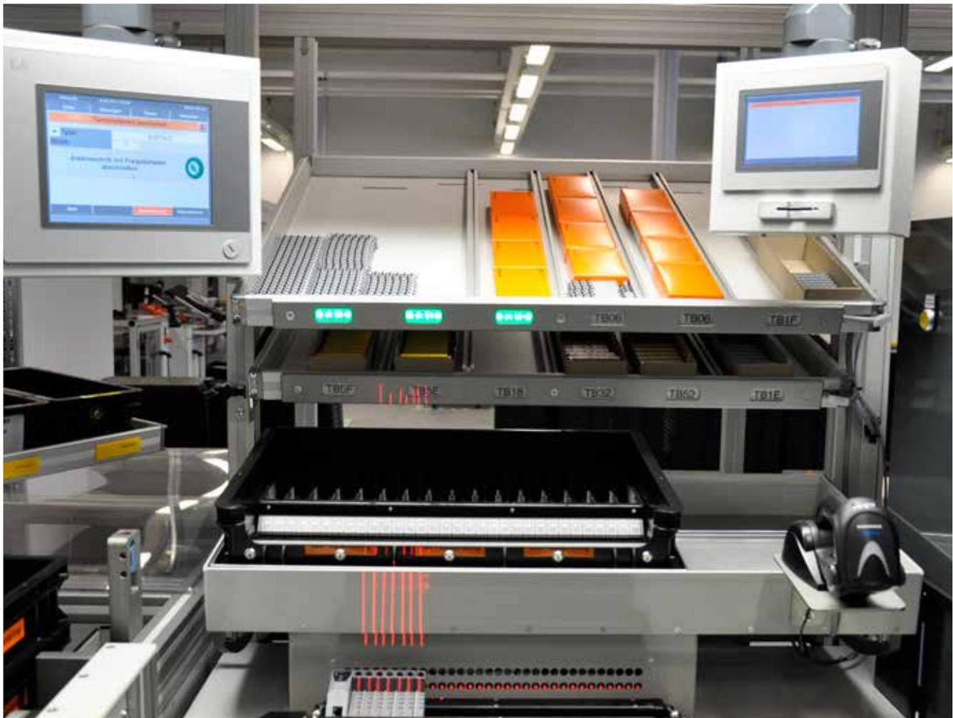
– etwa das Entnehmen von Schrauben – wird mit Pick-by-Light-Systemen unterstützt. Solche Hilfen haben sich auch schon in der Vergangenheit bewährt, etwa für die manuelle Bauteilebestückung in der Leiterplattenproduktion.
