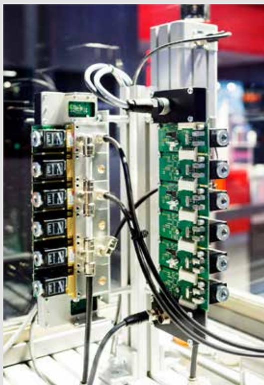
Das modulare, offene System „Open Frame“ ermöglicht individuelle Zusammenstellungen von Standardmodulen zur Regelung von Druck, Volumenstrom und einfachen Positionierantrieben.
