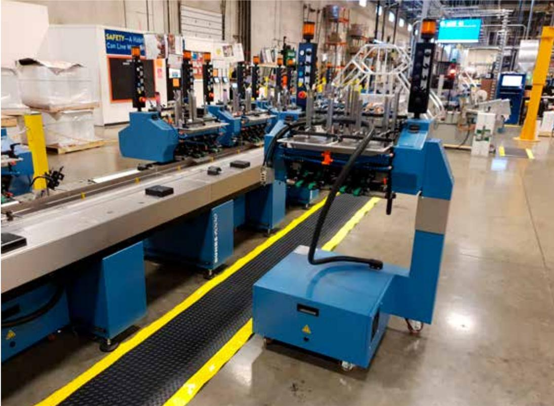
Das Safety-Hot-Swap-Feature von Sigmatek ermöglicht es, **Maschinenmodule mit Not-Halt-Funktion flexibel ins System einzubinden**, ab- und an anderer Stelle im Maschinenverbund wieder anzumelden.
