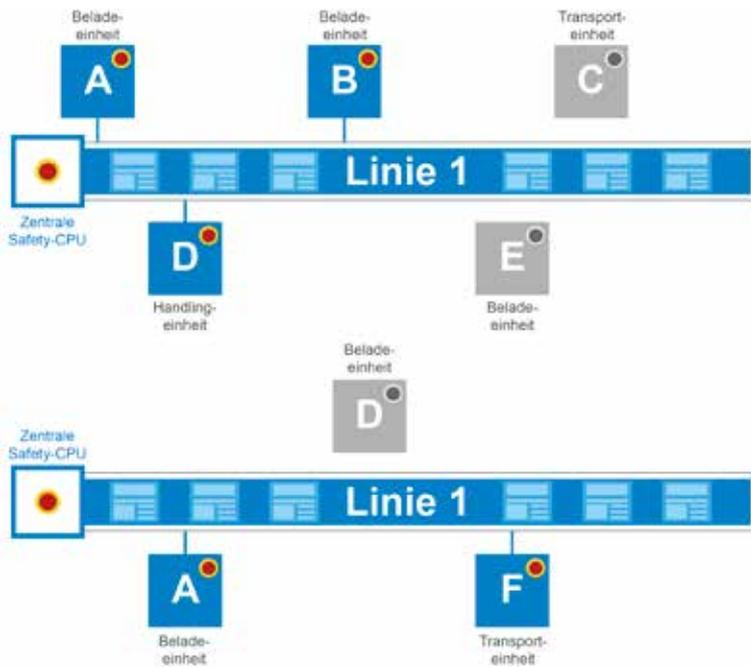
Das ab sofort verfügbare Safety-Hot-Plug-Feature von Sigmatek ermöglicht die **Rekonfiguration von Produktionsanlagen während des laufenden Betriebes** durch freizügiges Umgruppieren von Unterstationen.
