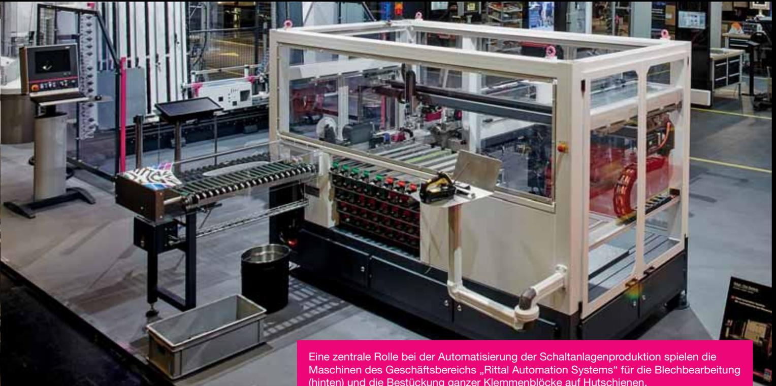
Eine zentrale Rolle bei der Automatisierung der Schaltanlagenproduktion spielen die Maschinen des Geschäftsbereichs „Rittal Automation Systems“ für die Blechbearbeitung (hinten) und die Bestückung ganzer Klemmenblöcke auf Hutschienen.
