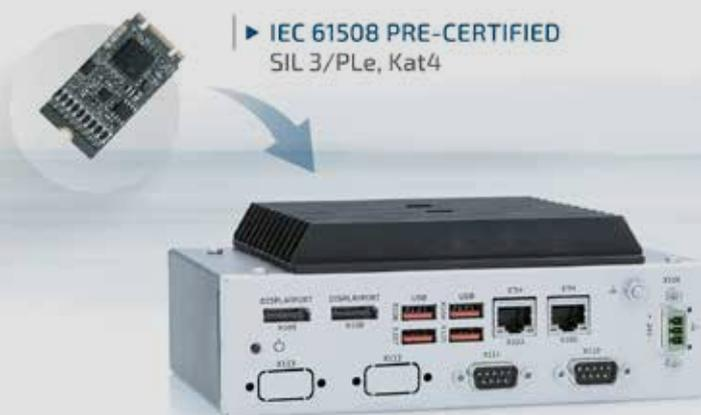
In Form einer Erweiterungskarte zur Integration in unterschiedliche Rechnerplattformen bietet Kontron eine **modulare, universelle Sicherheitssteuerung bis SIL Level 3 bzw. PLe, Kat4** an. Vor allem OEMs erleichtert und beschleunigt ein nach IEC 61508 vorzertifizierter Industrie-PC als Plattform für anwendungsspezifische Lösungen die Implementierung.
