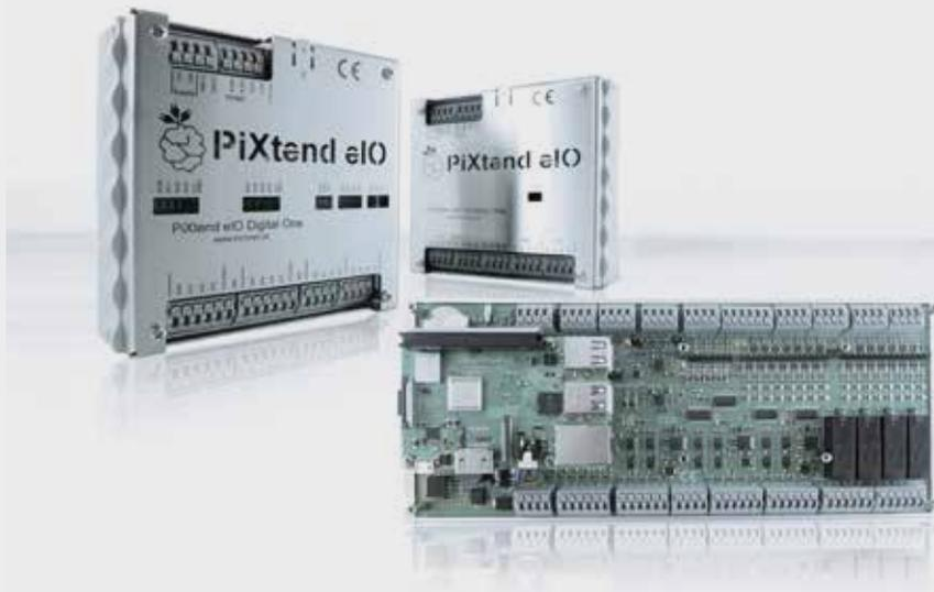
Mitte 2020 übernahm Kontron das Produktspektrum der Marke PiXtend im Bereich der **Steuerungshardware auf Basis des sehr populären Raspberry Pi**. Die industrietauglichen Steuerungsbaugruppen und I/O-Erweiterungen lassen sich in C oder Python programmieren, aber auch mit Codesys.
