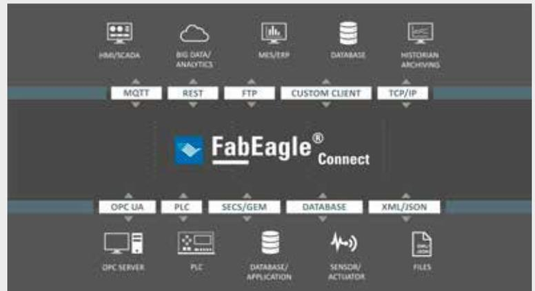
Die Software FabEagle für die Schnittstellenintegration **fasst wie ein Schweizer Messer alle gängigen Protokolle zusammen** und hilft Anlagenherstellern und -betreibern so, die mangelnde Einheitlichkeit in der industriellen Datenkommunikation zu überwinden und die Abhängigkeit von den Herstellern der einzelnen Anlageeile zu verringern.
