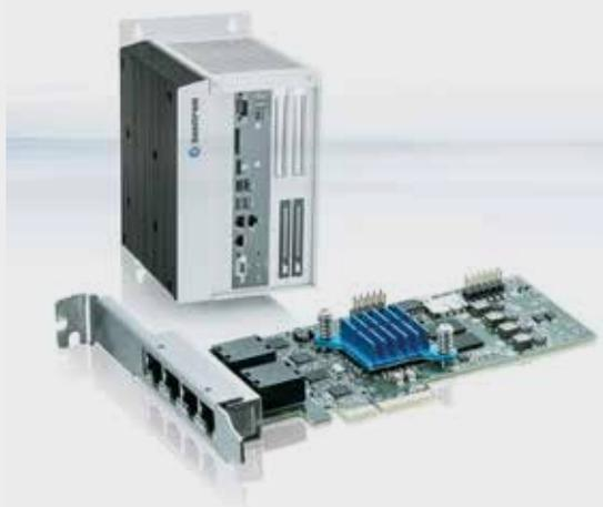
Das vor knapp drei Jahren vorgestellte Starterkit für TSN unterstützt nach einem FPGA-Softwareupgrade nun auch Standards wie IEEE 802.1Qbu und 802.1CB und **enthält den quell-offenen Stack nach open 62541 für OPC UA over TSN** mit PubSub.
