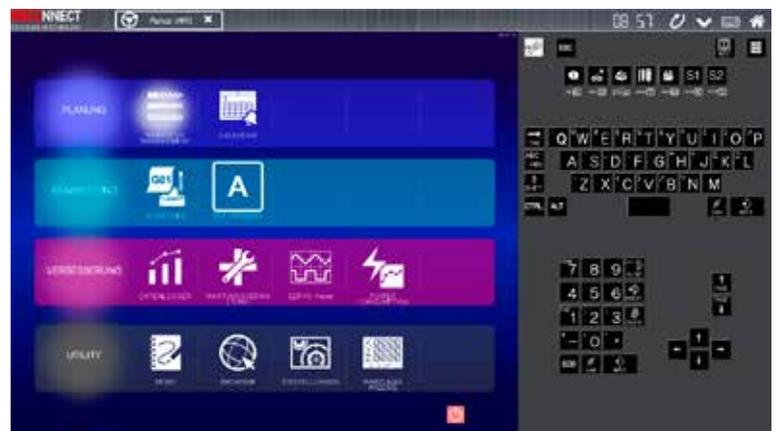
Die Bedienung von iHMI (hier eingebettet in EMCONNECT) erfolgt **mit intuitiven Menüs und animierten Funktionen** für die Bereiche Planen, Bearbeiten, Verbessern und Hilfsfunktionen.
