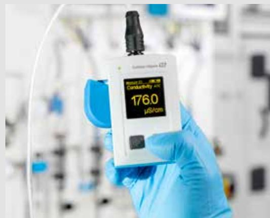
**Das mobile Multiparameter-Handmessgerät Liquiline Mobile CML18** für die Analyse eignet sich zur Durchführung von Messungen von pH/REdox, Leitfähigkeit, Sauerstoff und Temperatur in allen Branchen.
