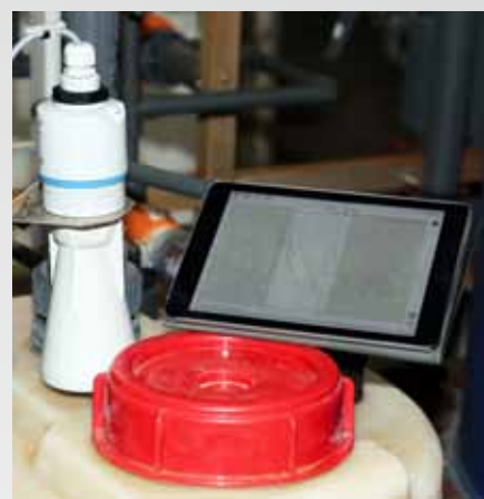
Bluetooth-Kommunikation über die SmartBlue-App auf mobilen Endgeräten vereinfacht Inbetriebnahme, Betrieb und Wartung von Geräten wie dem Radar-Füllstandsmessgerät Micropilot FMR10.
