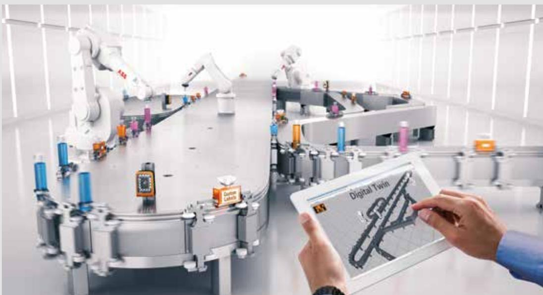
Der Roboter kann z. B. ein Werkstück ergreifen oder bearbeiten, **während sich dieses mit hoher Geschwindigkeit bewegt**, etwa auf einem Werkstücktisch oder auf einem Track-System wie ACOPOSTrak. Der Produktionsprozess muss dafür nicht verlangsamt werden. Die Bearbeitungszeit verkürzt sich wesentlich und die Produktivität steigt.
