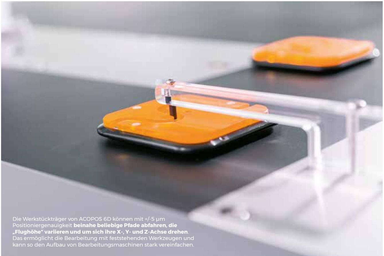
Die Werkstückträger von ACOPOS 6D können mit  $\pm 5 \mu\text{m}$  Positioniergenauigkeit **beinahe beliebige Pfade abfahren, die „Flughöhe“ variieren und um sich ihre X-, Y- und Z-Achse drehen.** Das ermöglicht die Bearbeitung mit feststehenden Werkzeugen und kann so den Aufbau von Bearbeitungsmaschinen stark vereinfachen.
