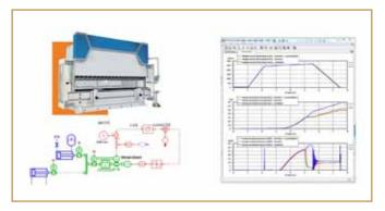
Ein Hersteller verbesserte die Energieeffizienz seiner Abkantpressen. Die Überprüfung der geplanten Maßnahmen mittels 1D-Simulation mit LMS Imagine.Lab Amesim noch vor dem ersten Handgriff in der Konstruktion bestätigte die Reduktion des Energieverbrauchs um 28 %.
