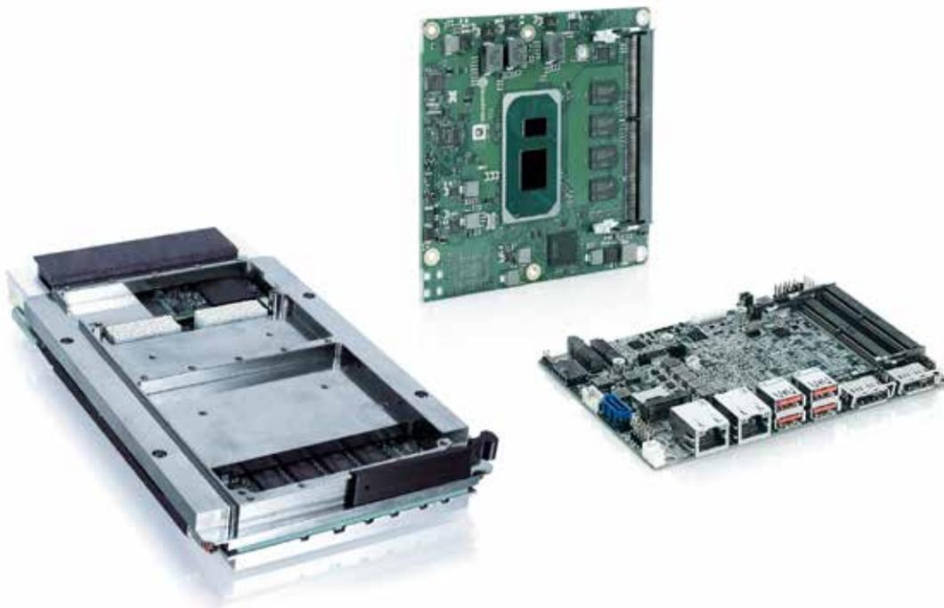
**Kontron stattet immer mehr Produkte im Standard mit TSN-Fähigkeit aus**, etwa COM Express-Module, 3HE VPX-Blades und 3,5 Zoll SBCs mit den Intel Core-Prozessoren der elften Generation. Auch TSN-fähige Switch-Produkte stehen auf der Roadmap.
