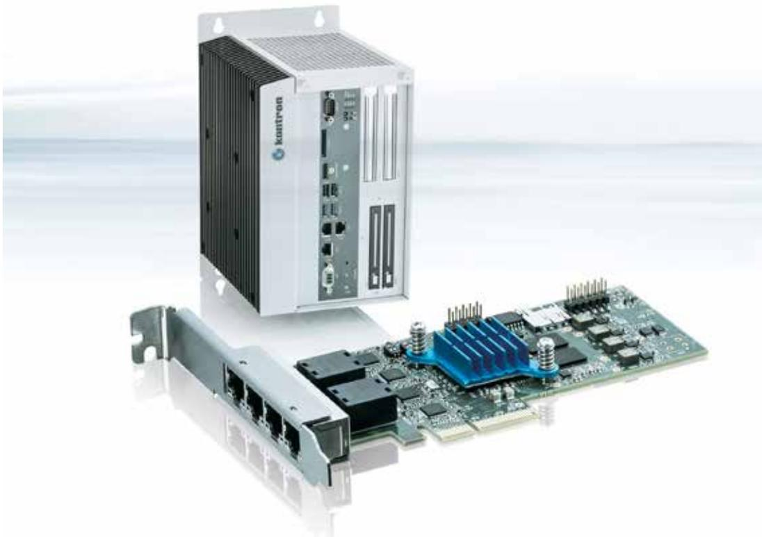
**Das Kontron TSN-Starterkit ermöglicht Konfiguration und Monitoring von TSN-Netzwerken.** Mit einer PCI Express®-Karte und passender Software können IPCs für TSN nachgerüstet werden.
