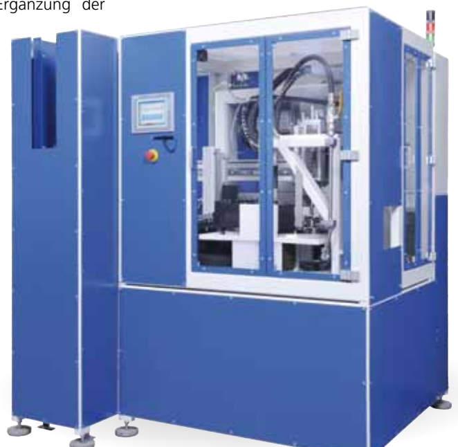
Den unterschiedlichen Ausführungen des kompakten OSSBERGER Coli-Cleaners (hier mit Rundtakt-Schaltteller) gemeinsam ist die kleine Aufstellfläche.
