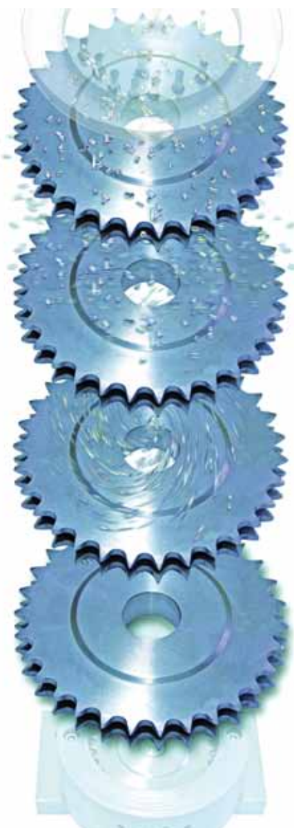
Prinzip der Vibrationsreinigung: Das verschmutzte Werkstück wird in Schwingungen versetzt. Nach dem Absaugen von festen und flüssigen Verunreinigungen bleibt das gereinigte Werkstück zurück.
