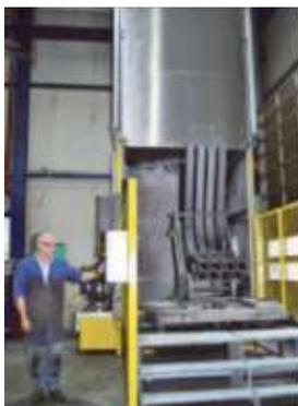
Bei ALPLA erfolgt die Reinigung von Bauteilen für Kunststoff-Spritzwerkzeuge in einer MAFAC PALMA auf denselben Vorrichtungen wie ihre Zerspanung. Bei Gassner Stahlbau erfolgt die Reinigung gebogener Formrohre in einer BUPI CLEANER® POWERTEC in extra hoher Sonderausführung.
