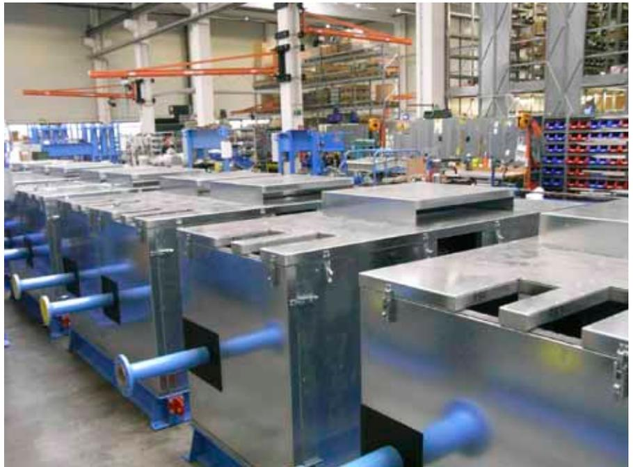
Der servoelektrische Pumpenantrieb senkt die Geräuschemissionen um 15 dB und macht umfangreiche und teure Lärmschutzmaßnahmen wie bei diesen klassischen Verstellpumpenantrieben überflüssig.
