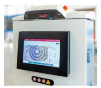
Mithilfe der Fahrzeugsoftware Arcos beherrschen FTS von DS Automotion zusätzlich zum Betrieb mit physischer oder virtueller Spurführung sowie konturbasierter freier Navigation auch das kooperative und kollaborative Navigieren.
