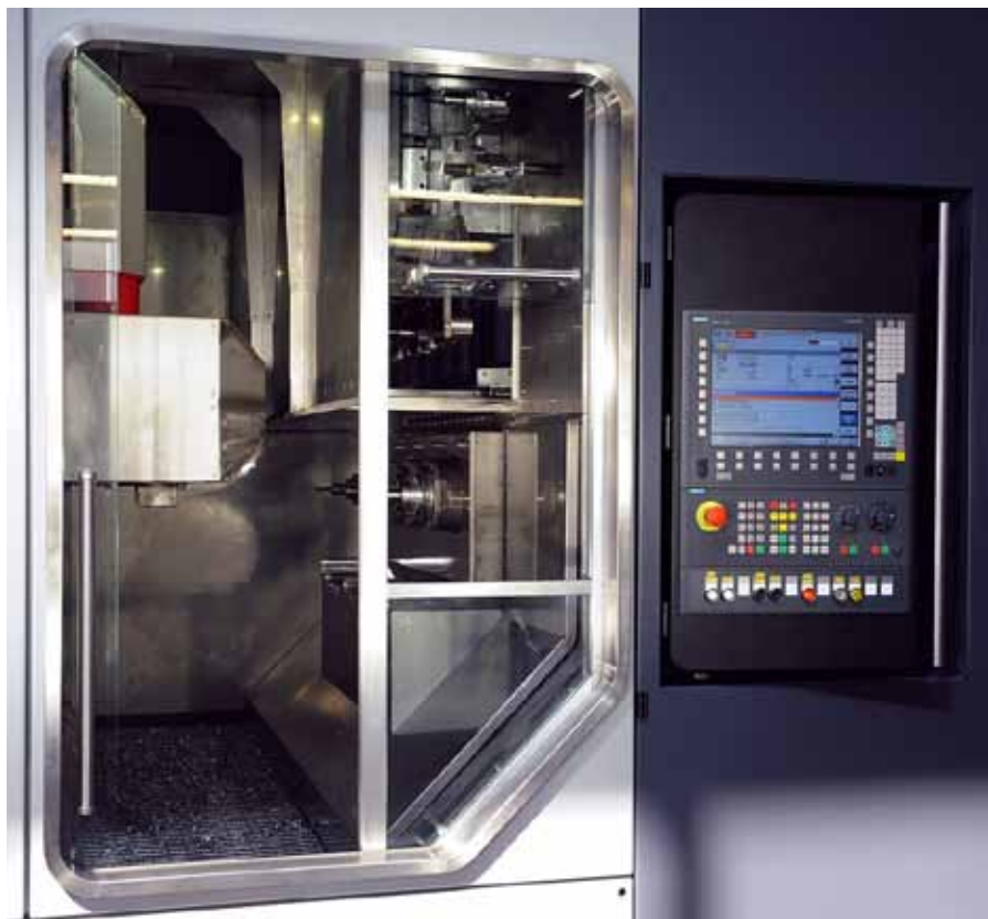
Die Hauptbedieneinheit wird dominiert von einem SINUMERIK OP015AT mit Maschinensteuertafel, die bündig im Maschinengehäuse versenkt werden kann. Ohne einen separaten PC läuft auch die Aufbereitung aller Visualisierungsdaten auf der SINUMERIK.
