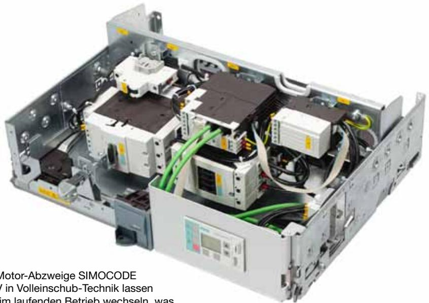
Die Motor-Abzweige SIMOCODE pro V in Volleinschub-Technik lassen sich im laufenden Betrieb wechseln, was die Stillstandszeiten erheblich verkürzt.
