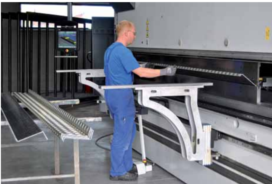
Die von der PC-basierten CNC-Steuerung CADMAN® Touch erstellte 3D-Biegesimulation ist auch eine wertvolle Arbeitshilfe für das Bedienungspersonal.
