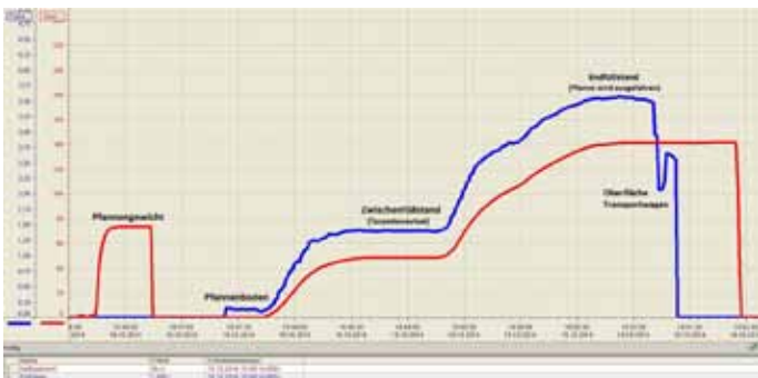
Das Trend-Diagramm zeigt die Korrelation der Daten aus Verwiegung und Füllstandsmessung.
