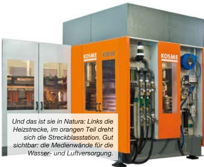
Und das ist sie in Natura: Links die Heizstrecke, im orangenen Teil dreht sich die Streckblasstation. Gut sichtbar: die Medienwände für die Wasser- und Luftversorgung.
