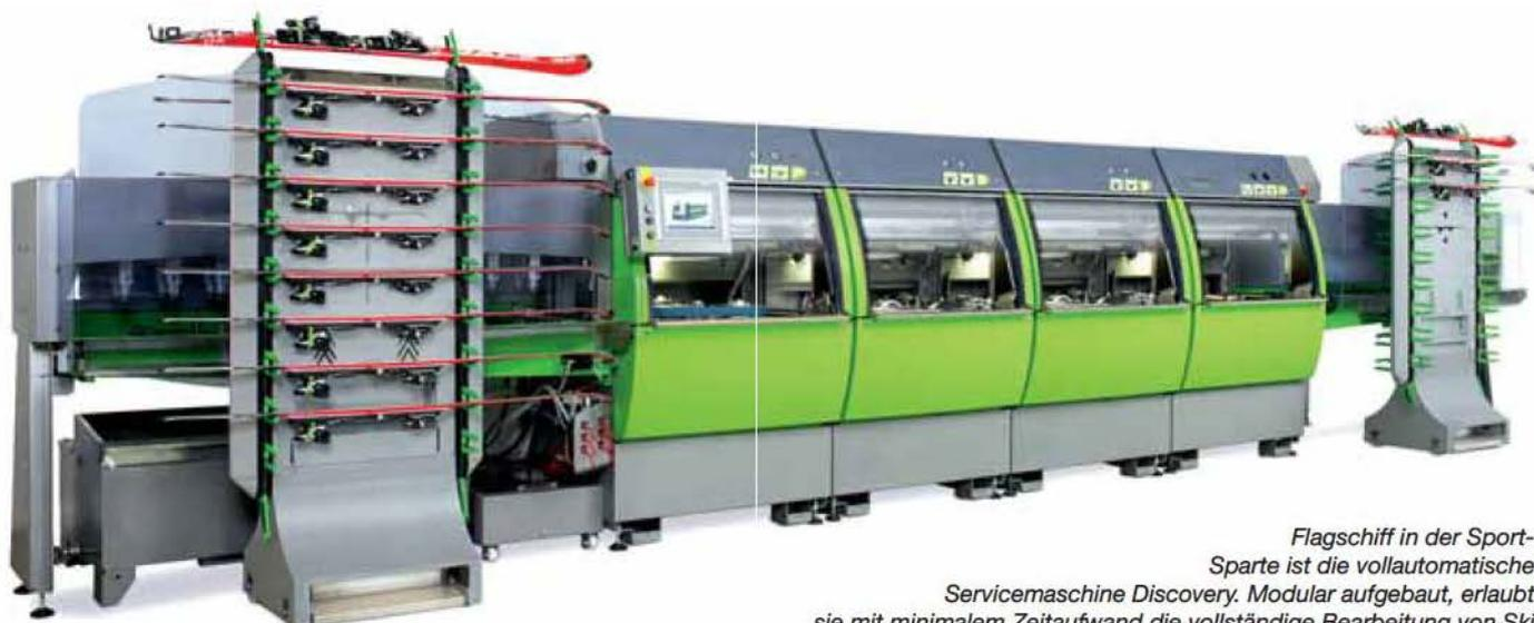
Flagschiff in der Sport-Sparte ist die vollautomatische Servicemaschine Discovery. Modular aufgebaut, erlaubt sie mit minimalem Zeitaufwand die vollständige Bearbeitung von Ski und Snowboards vor jedem neuen Verleihvorgang.
