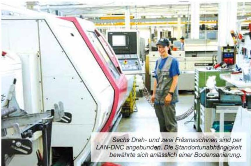
Sechs Dreh- und zwei Fräsmaschinen sind per LAN-DNC angebunden. Die Standortunabhängigkeit bewährte sich anlässlich einer Bodensanierung.
