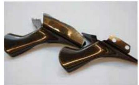
Carbo Tech fertigt Kohlefaser-Verbundteile für die Automobilindustrie. Rohteile aus dem Autoklaven (links) erhalten durch Beschneiden die endgültige Kontur. Im Bild Außenspiegel-Halterungen für Aston Martin.
