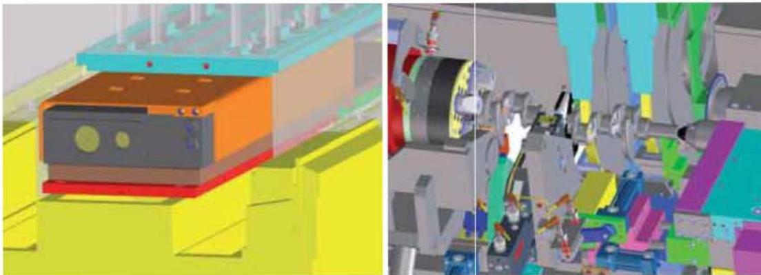
**links** Erstmals bei GST kamen Linearmotoren zum Einsatz. Es handelt sich um Siemens 1FN3 Linearantriebe in kompaktem Design mit hoher Leistungs-/Kraftdichte.
