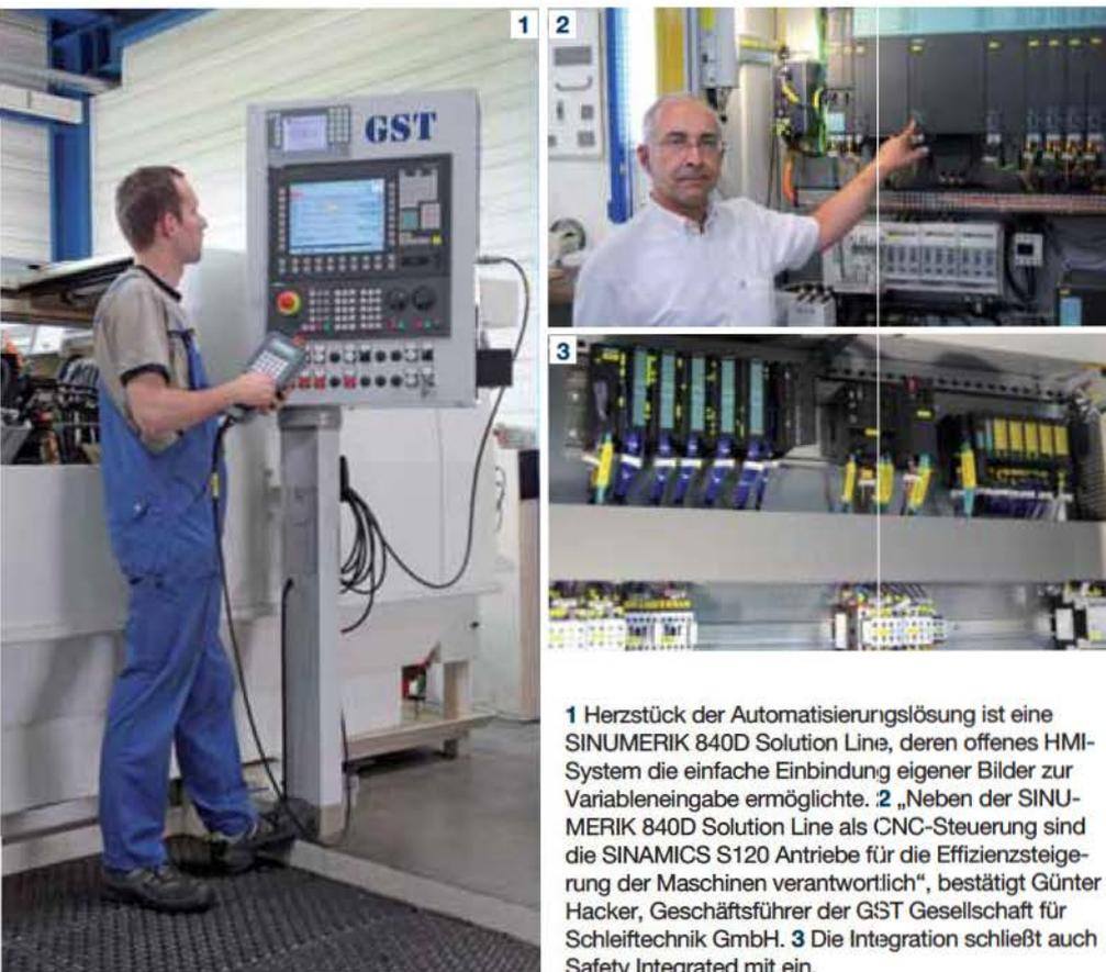
**1** Herzstück der Automatisierungslösung ist eine SINUMERIK 840D Solution Line, deren offenes HMI-System die einfache Einbindung eigener Bilder zur Variableneingabe ermöglichte. **2** „Neben der SINUMERIK 840D Solution Line als CNC-Steuerung sind die SINAMICS S120 Antriebe für die Effizienzsteigerung der Maschinen verantwortlich“, bestätigt Günter Hacker, Geschäftsführer der GST Gesellschaft für Schleiftechnik GmbH. **3** Die Integration schließt auch Safety Integrated mit ein.
