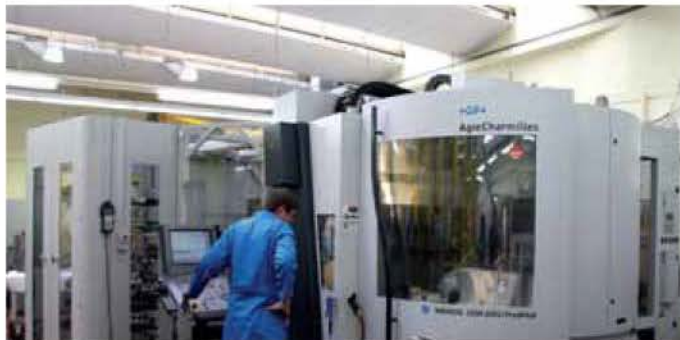
Trotz der umfangreichen Automatisierungslösung benötigt die MIKRON HSM 600U ProdMod nur sehr wenig Aufstellfläche. Die Programmierung erfolgt ausschließlich per CAD/CAM-Lösung Hypermill und Datenimport an der Heidenhain iTNC 530.
