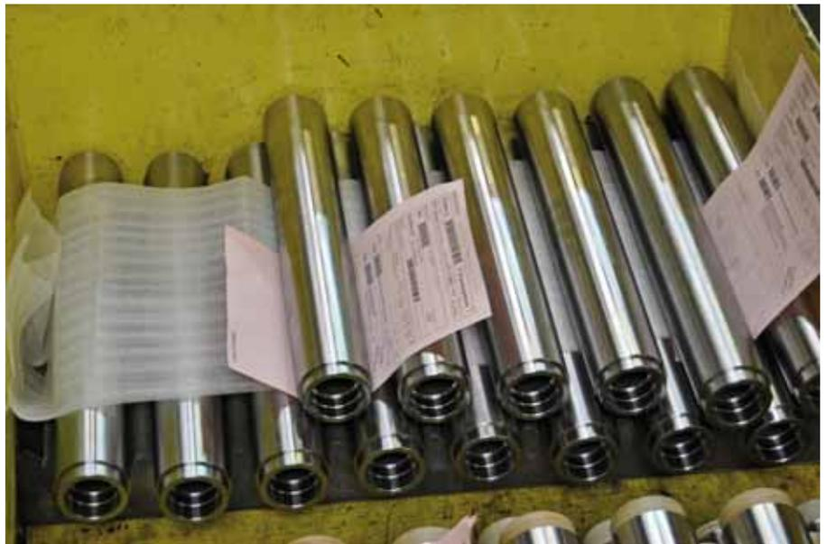
Der Eigenfertigungsanteil geht gegen 100 Prozent. So werden Antriebswalzen für Rollenbatterien und Förderbänder in hoher Stückzahl aus solchen Rohren gedreht.
