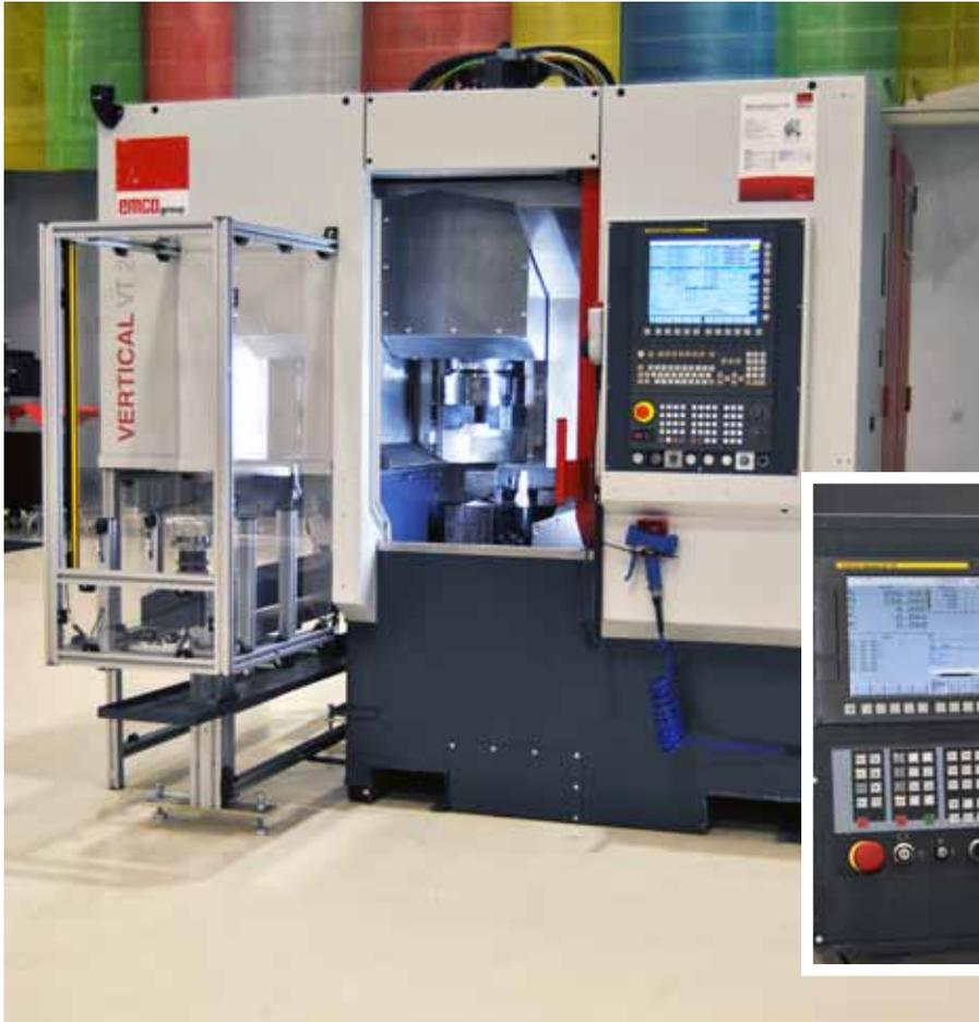
**links** Auf der AMB 2016 zeigte Emco ein Vertikalbearbeitungszentrum VT260 mit Übergabestation von Emco Magdeburg, über dessen Steuerung Fanuc 31i-Model B auch die Bedienung des be- und entladenden Fanuc-Roboters erfolgte.
