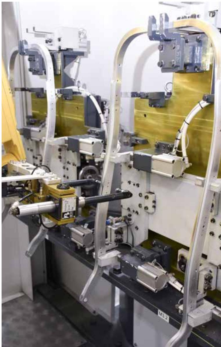
Unter Verwendung von in der Konzernmutter hergestellten Aluminium-Stranggussprofilen produziert die Alu Menziken Euromotive GmbH unter anderem Strukturen für Passagiersitze in Flugzeugen. Deren bis zu **120 Bohrungen werden in einer Roboterzelle von Weldstone entgratet.**
