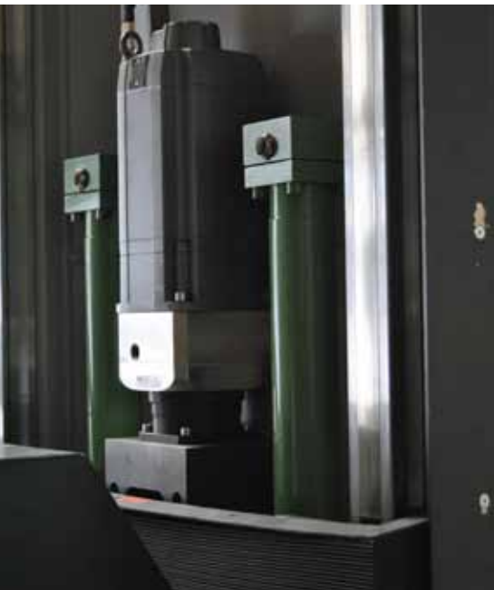
Der Antriebsstrang der Z-Achse kommt ab dem Motor ebenfalls komplett von TAT: Dieser treibt über ein Planetengetriebe und eine spielfreie Klauenkupplung einen geschliffenen Kugelgewindetrieb mit ca. 2 m Länge an. Zur Abdeckung der Z-Achse liefert TAT den im unteren Bildabschnitt sichtbaren Faltenbalg.
