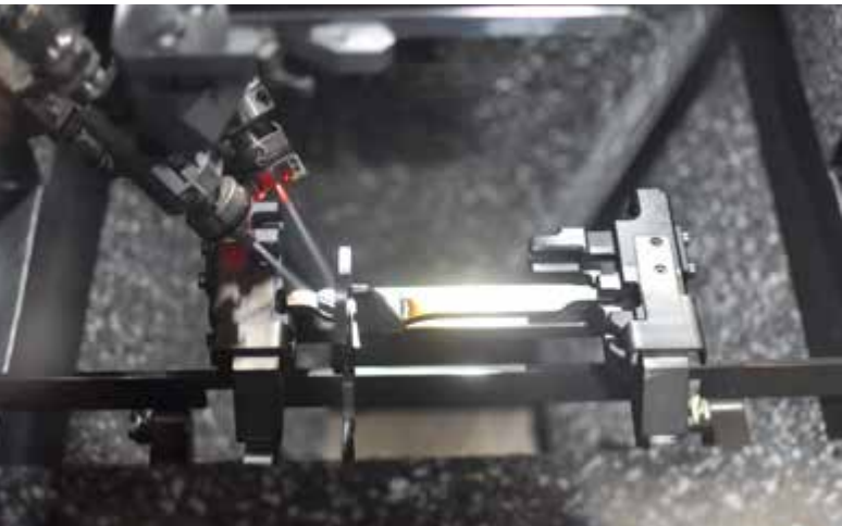
Flüssiges Kohlendioxid entspannt beim Austritt aus der Zweistoff-Ringdüse des quattroClean-Systems zu feinen CO 2 -Kristallen.
