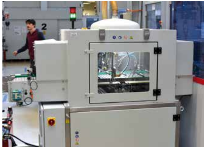
Die anschließende Konservierung der Teile in einem von ebenfalls von MAP Pamminger gelieferten Durchlaufkonservierer von SLE Technology.
