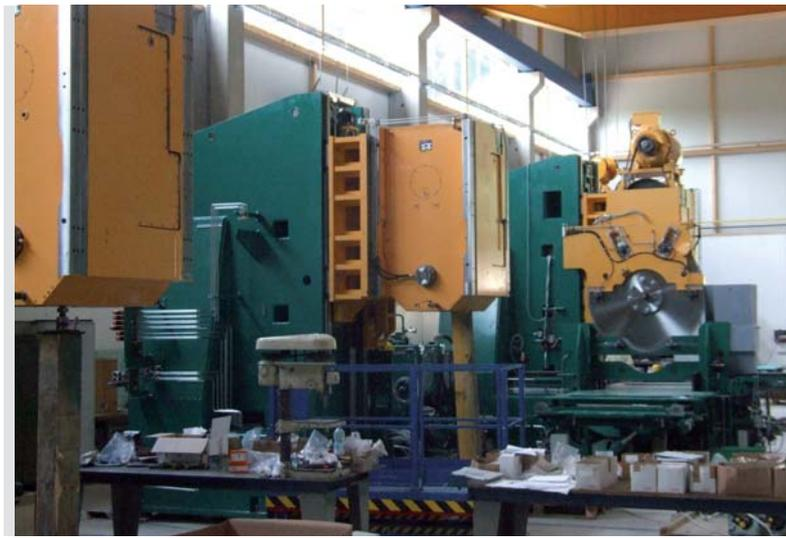
*Erster Fertigungsschritt in der Metallbearbeitung ist oft das Ablängen der zu bearbeitenden Stücke. Schnell und präzise schneidet diese für China bestimmte Lagensäge ganze Bündel von Stangenmaterial.*
