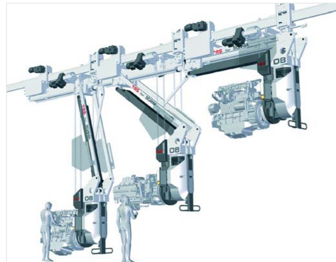
Wo Mensch und Maschine miteinander in Einklang zu bringen sind, ist Design gefragt. TMS Engine Carrier als Teil einer Fertigungsanlage für Dieselmotoren.
