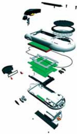
Ergebnis des Designprozesses sind fertigungsreife Daten für den Werkzeugbau. Durchgängige Einbeziehung aller Komponenten in die Gestaltung erspart Überraschungen.
