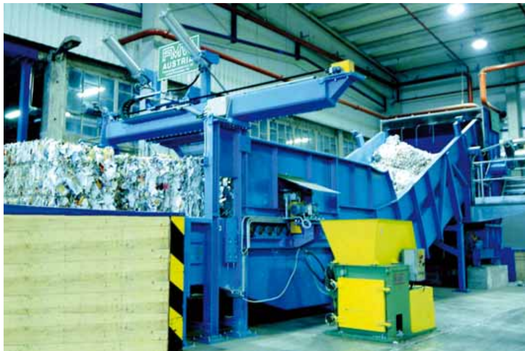
Mit mehreren 10.000 Einzelteilen und Baugruppen nur ein kleiner Teil einer Gesamtanlage: FMW-Altpaperentdrachtungsanlage Extractor
