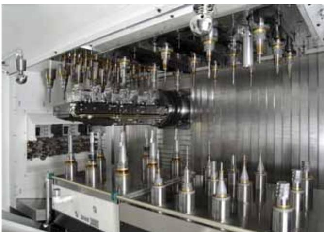
Der bewegliche Werkstückträger wird zur Bearbeitung gegen die über 80 Bearbeitungsspindeln geführt.
