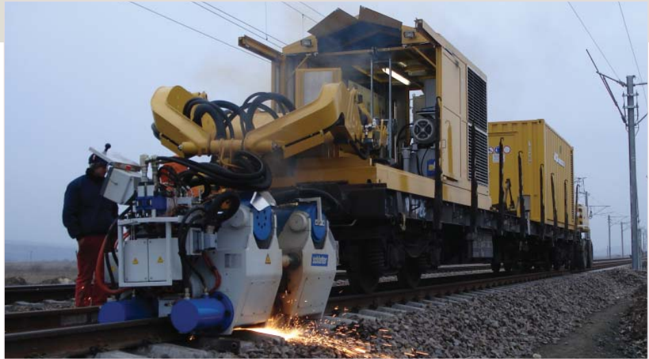
Schlatter erzeugt auch ortsfeste und mobile Anlagen zum nahtlosen Verschweißen von Eisenbahnschienen.
