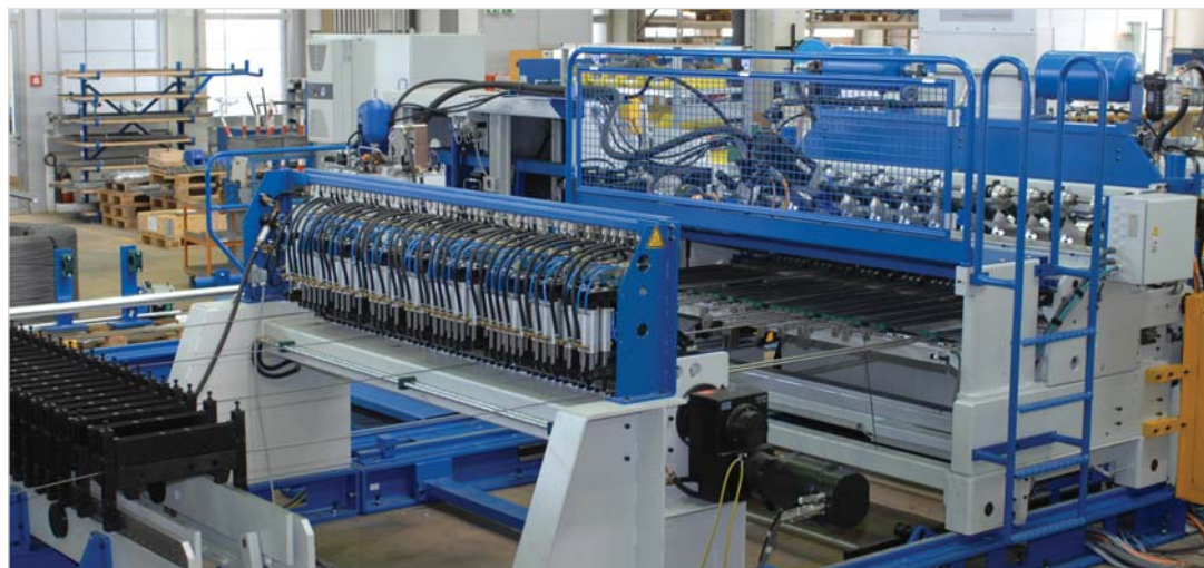
Schlatter Industries ist ein weltweit führender Hersteller komplexer Anlagen zur Herstellung von Metallgittern. Die Konstruktion dieser Armierungsgitter-Schweissanlage erfolgte wie die aller Schlatter-Produkte in NX.
