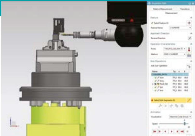
Die Verwendung eines digitalen Zwillings der Messanlage in NX CMM ermöglicht fehlerfreie Messungen.
