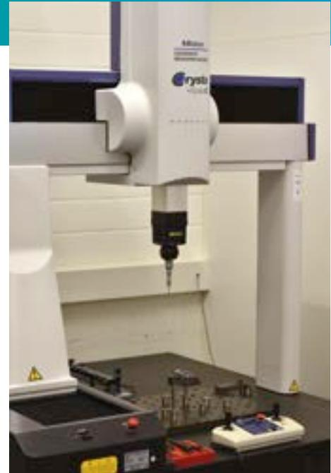
Teil des Herstellungsprozesses ist die Vermessung aller Teile auf einer Koordinatenmessmaschine zur Erfüllung der Nachweispflichten.
