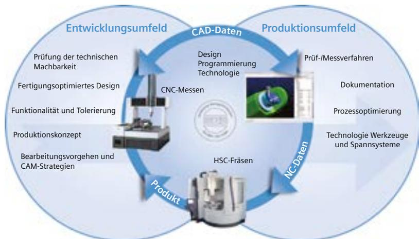
C-Mill hat die gesamte Prozesskette von CAD und CAM über HSC-Fräsen bis zur Teilevermessung mittels NX digitalisiert.
