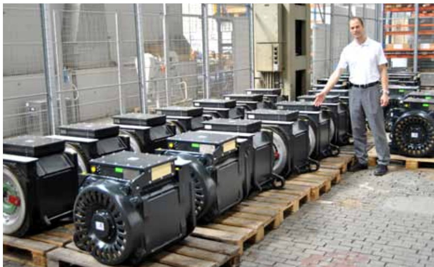
Insgesamt acht solcher Antriebe der Type TMF59-33-4 von Traktionssysteme Austria verleihen dem Doppelstock-Triebzug eine installierte Dauerleistung von 4 MW und eine kurzzeitige Spitzenleistung von 6 MW. „Mit 500 kW gehören diese Drehstrom-Asynchronmotoren zum Mittelfeld innerhalb unserer Produktpalette“, sagt Instandhaltungsleiter Thomas Kriegisch.
