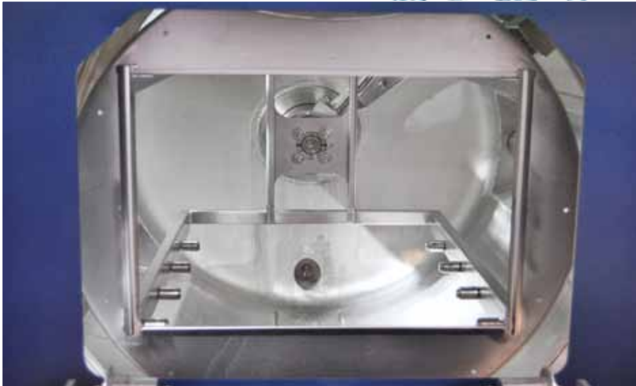
Schwierige Teilegeometrien beherrscht die Spritz-Flut-Reinigungsanlage mit Drei-Bad-Technik, da sowohl der Korb mit dem Waschgut als auch das Spritzdüsensystem unabhängig voneinander gedreht werden.
