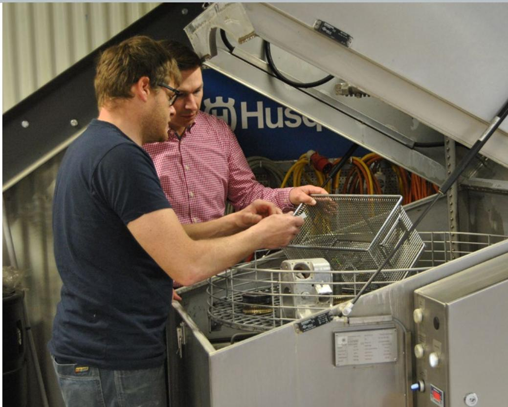
Vor Inspektion und Reparatur erfolgt die Reinigung der mit Betonrückständen und Öl verunreinigten Teile in einer Render-Teilereinigungsanlage WE 92 AM. Im Bild Martin Rettenbacher mit Kundenberater Gerald Leeb von der MAP PAMMINGER GMBH (hinten).
