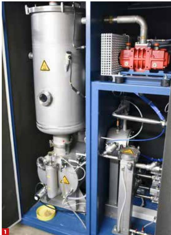
**1** Der kompakte PROVADEST P60/1 arbeitet nach dem Prinzip des Zwangsumlaufs und ist bei nur 1.790 x 920 mm Aufstellfläche **für eine Jahresleistung von 360 m<sup>3</sup> ausgelegt.**
