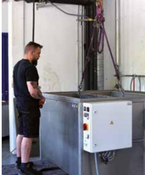
**Das Ultraschall-Reinigungsgerät von Rational mit ca. 1.300 Liter Füllvolumen.**
