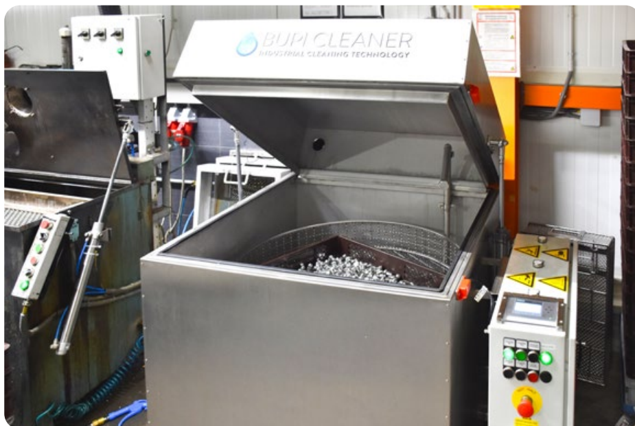
Ältere, selbst konstruierte Waschmaschinen (links) und eine Bupi Cleaner® Toploader TL80 dienen der groben Vorreinigung. Für die Gebindereinigung ist eine weitere gleichartige Reinigungsanlage im Einsatz.
