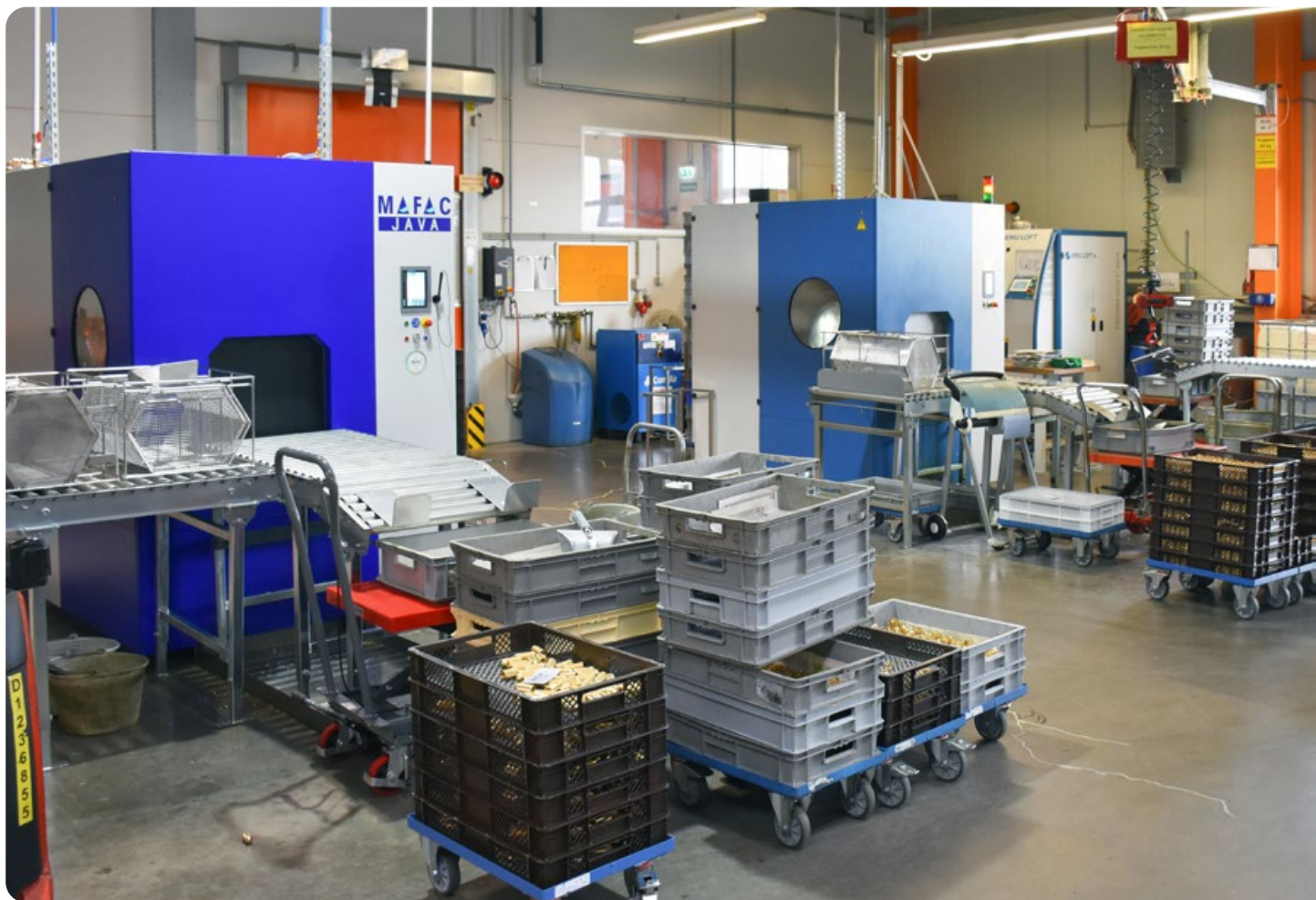
Seit dem jüngsten Zugang einer weiteren Spritzflutreinigungsanlage Mafac Java erfolgt die Teilereinigung bei ABW nach Materialien getrennt. (Bilder: Peter Kempfner)
