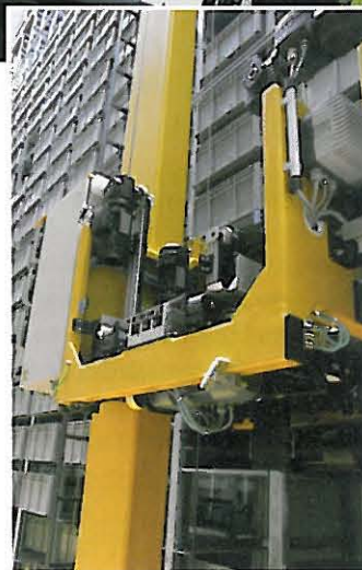
Lagerbediengeräte sind das Herzstück moderner Hochregallager.
