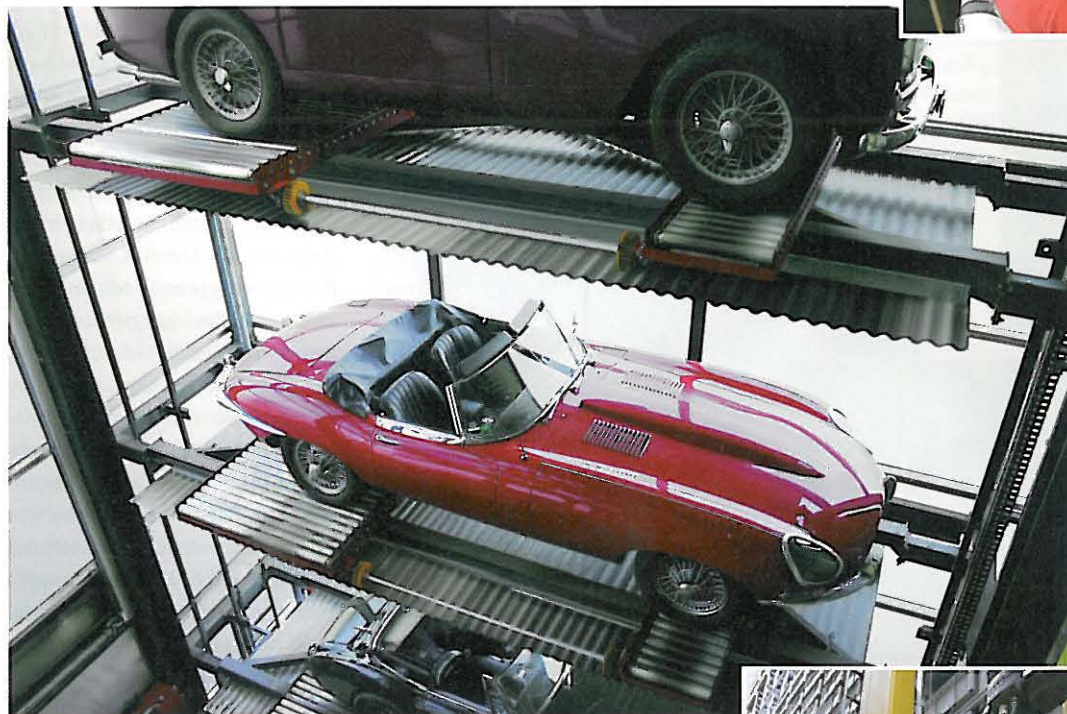
Parksysteme von LTW kommen mit der Hälfte der Fläche konventioneller Parkhäuser aus.
